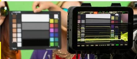
**파형 모니터:** 파형 모니터는 큰 그레이 스케일 칩과 함께 사용할 수 있으며 생산 전에 노출 설정을 할 때 도움이 됩니다. 큰 그레이 스케일의 값들은 위에 언급한 값들과 일치해야 합니다.
